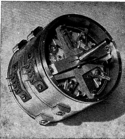
Fig. 3 - 13. — Potentiomètre sinus-cosinus (type Rotapot 122 F de M.C.B.-Véritable Alter).
